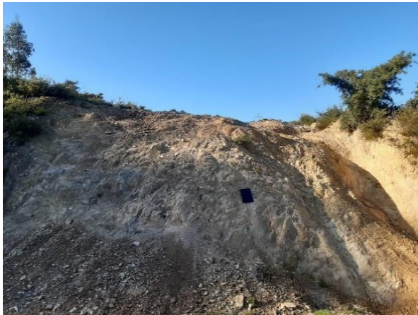
Fotografia 6.8 – Afloramento de grauvaques, com 5 m de altura e 10 m de comprimento no limite da área da Central Fotovoltaica com a área do corredor da Linha Elétrica.
